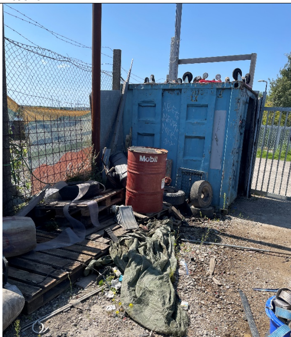
Foto 5 Olie-tønde, rusten, lukket, men uden spildbakke
