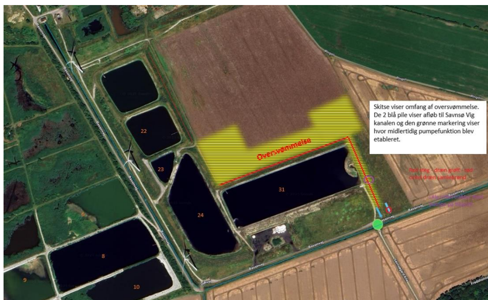
Figur 1 Bassinnumre, grøfter mm tegnet på tegning fra bilag 3 i NS NAK redegørelse for uheldet. overløbet d. 27-10-2025 fandt sted over kanten og eroderet dige i nordenden af bassin 24 imod marken og fra østsiden af bassin 23, der har været spildevand på hele det gule areal på marken.
