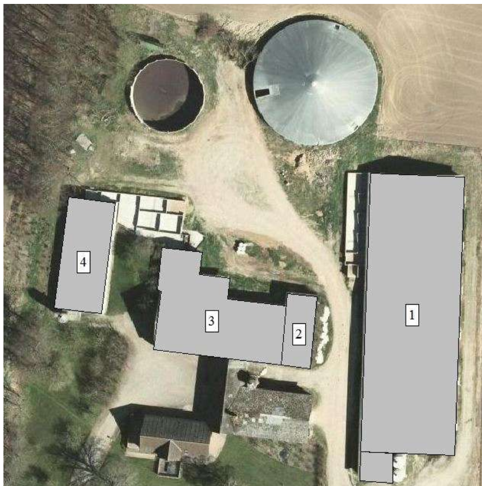
Figur 1: Staldafsnit 1 (drænet gulv + spalter (33/67)): 1.200 stipladser; Staldafsnit 2 (drænet gulv + spalter (33/67)): 120 stipladser; Staldafsnit 3 (fuldspaltegulv ændres til drænet gulv + spalter (33/67)): 580 stipladser; Staldafsnit 4 (drænet gulv + spalter (33/67)): 300 stipladser.
