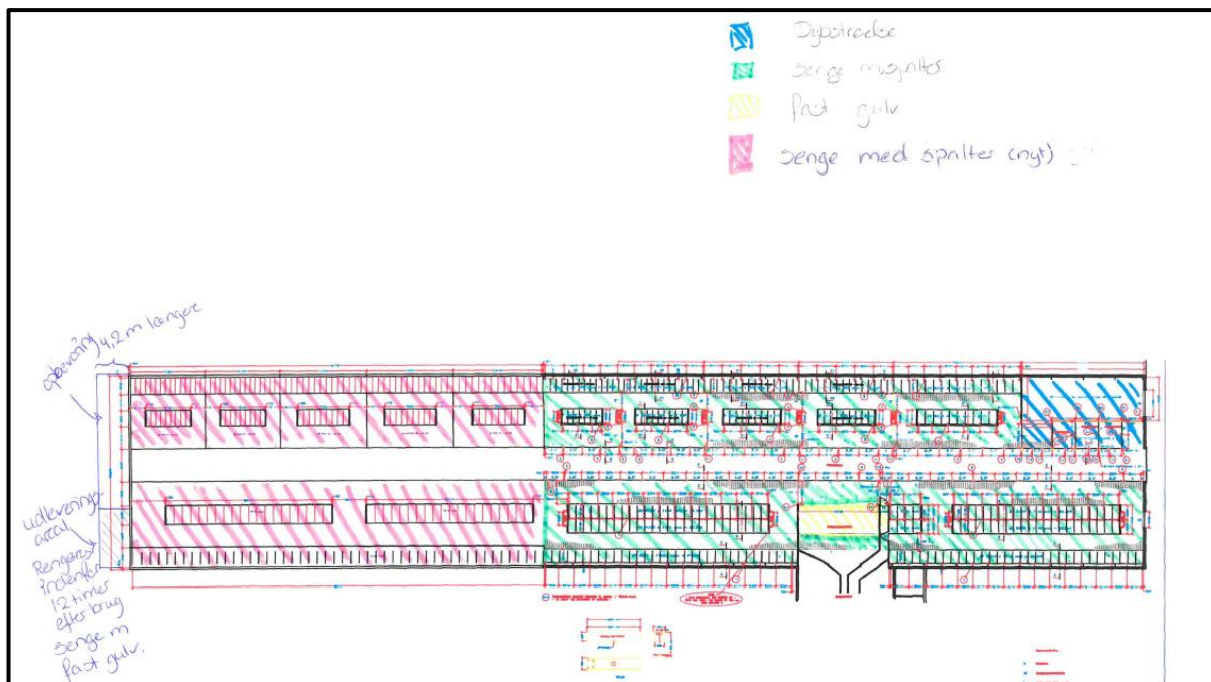
Figur 3. Plantegning af spaltestald (bygning 1 og 1a) med angivelse af placering af de forskellige typer produktionsareal. Udleveringsarealet er i dette tillæg medtaget som produktionsareal under de 1.510 m 2 angivne spaltetegulv.
