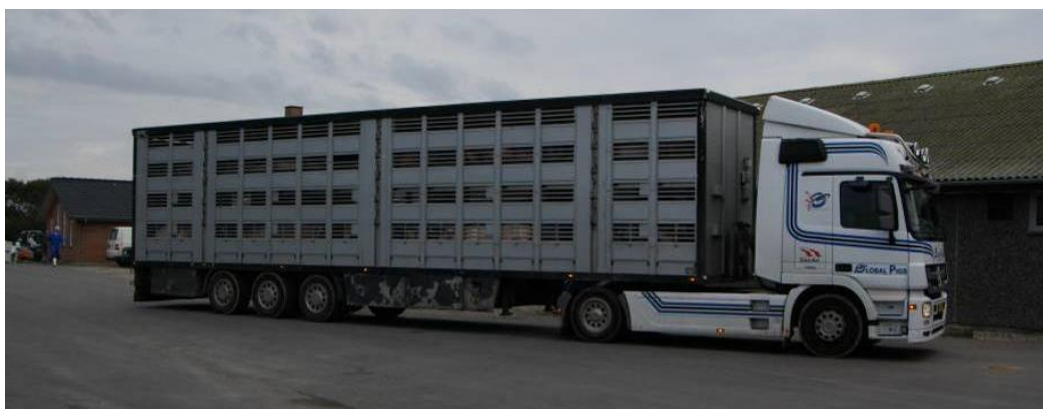
Foto 16: Tilførsel af grise med trailer og lad i flere etager (0101.jpg)
