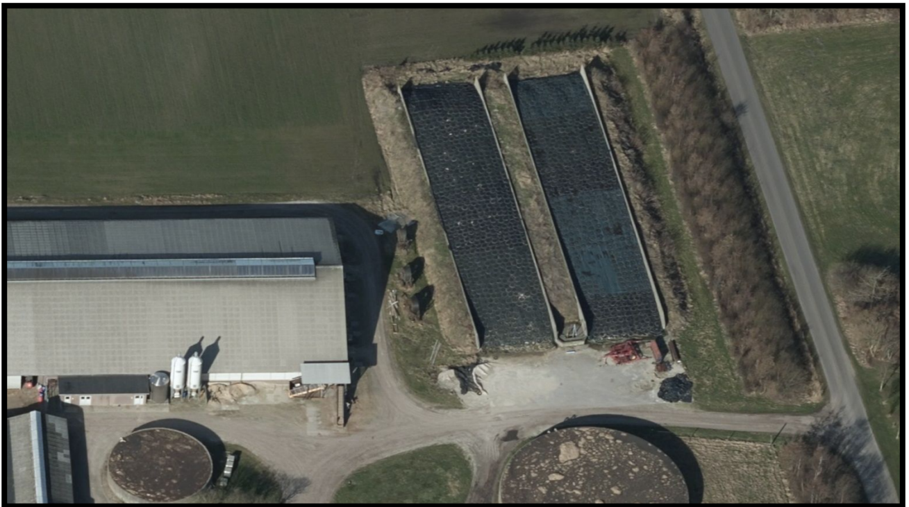
Figur 3 Vandet fra siloen ligger helt op ad plastikken, da hældet fra forpladsen falder ind i siloen.
