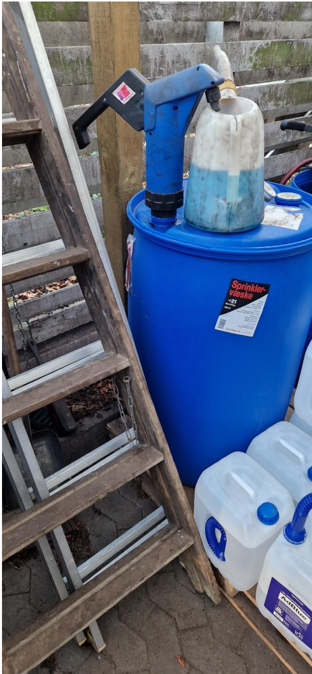
Sprinklervæske står uden spildsikring umiddelbart ved siden af spildrist over opsamlingssump.
