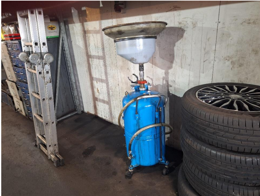
S.V.Auto på bådehavnsgade 22, anvender olieopsamler til at opsamle olie fra biler.
