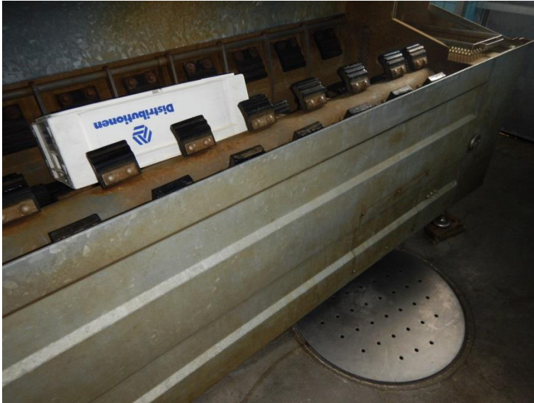
1. Afløb til vaskevand.
