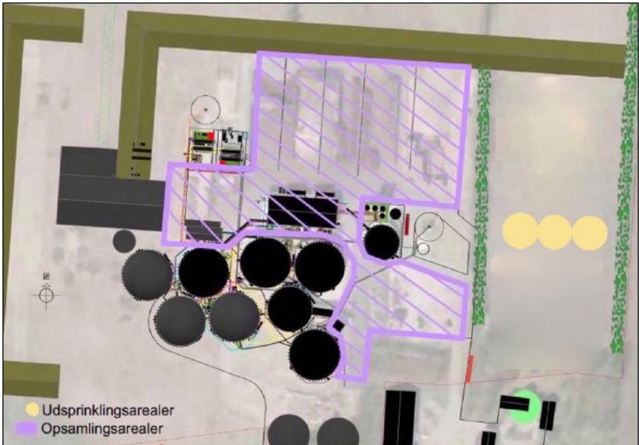
Figur 3 – Oversigtskort over arealer hvorpå der opsamles vand der kan udsprinkles, og placering af sprinkleranlæg, hvor én sprinkler er i drift ad gangen.
