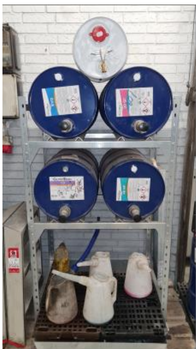
Billed 2. på billedet ser man autoværkstedets oplag af kølervæske. Som man kan se opbevares kølervæsken i tønder på et stativ med en spildbakke under.
