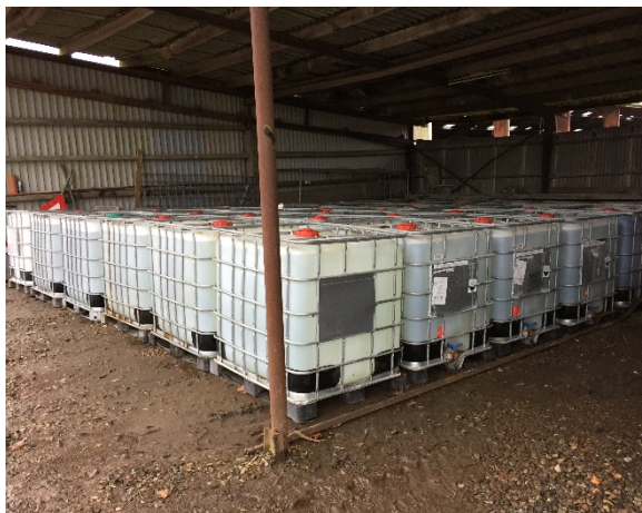
Pallettanke med svovlsyre opbevares på jord under halvtag - 1.12.2016
