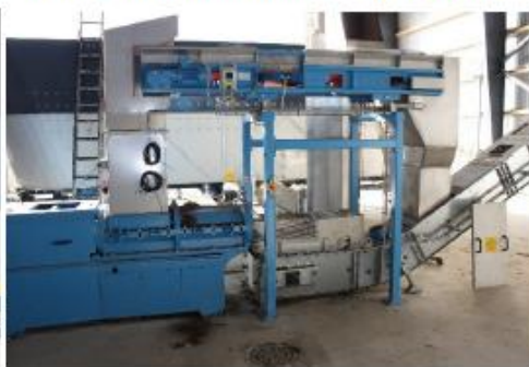
Extruder og start på indfødning med redler
