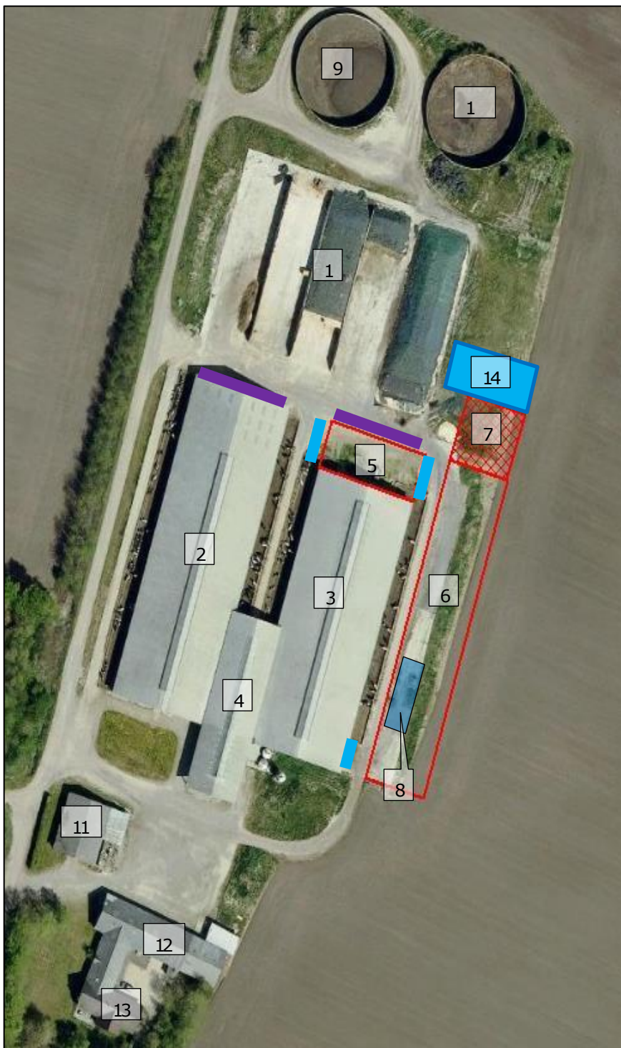
Figur 7. Situationsplan (Blå streg = forlængelse af udvendige foderbord og gangarealer, lilla streg = udvendig foderbord).
