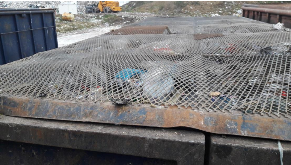
Figur 4: En af containerne var aflukket med defekt trådnet.
