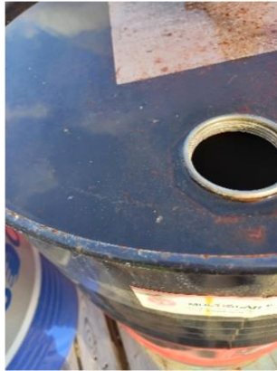
Spildolie blev opbevaret udendørs uden overdækning og uden spildbakke, og der manglende en prop.
