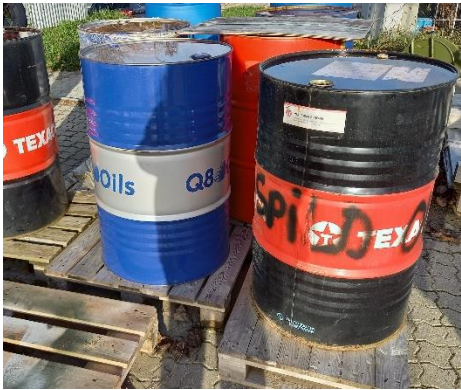
Spildolie blev opbevaret udendørs uden overdækning og uden spildbakke, og der manglende en prop.
