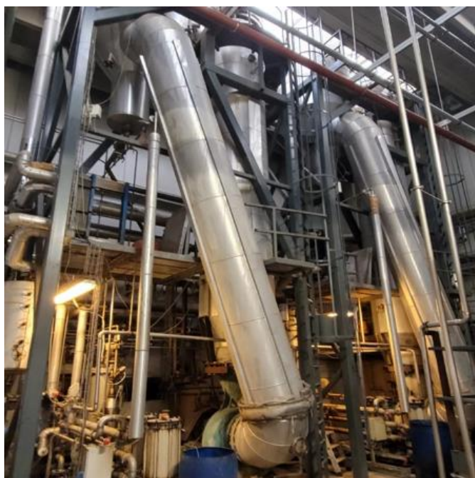
De to inddamper kolonner, som benyttes til behandling af vandigt farligt affald.
