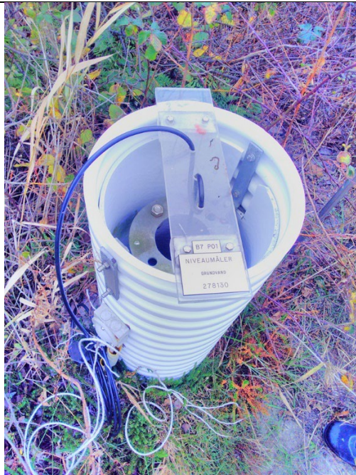
Grundvandspejling og prøvetagningsbrønd (B7P01)
