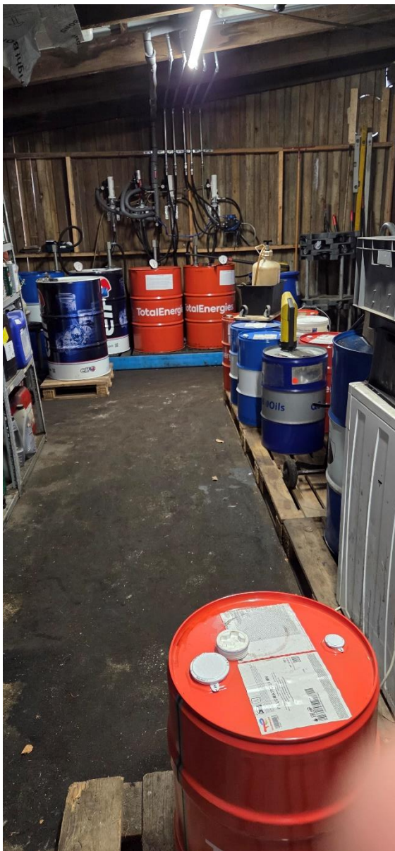
Motorolie m.m. i tromler opbevares delvist med spildbakker og delvist uden spildsikring.
