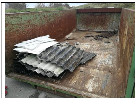
Asbestcontainer på tilsynsdagen den 23. september 2019. I containeren er der både hele og knækkede plader.
