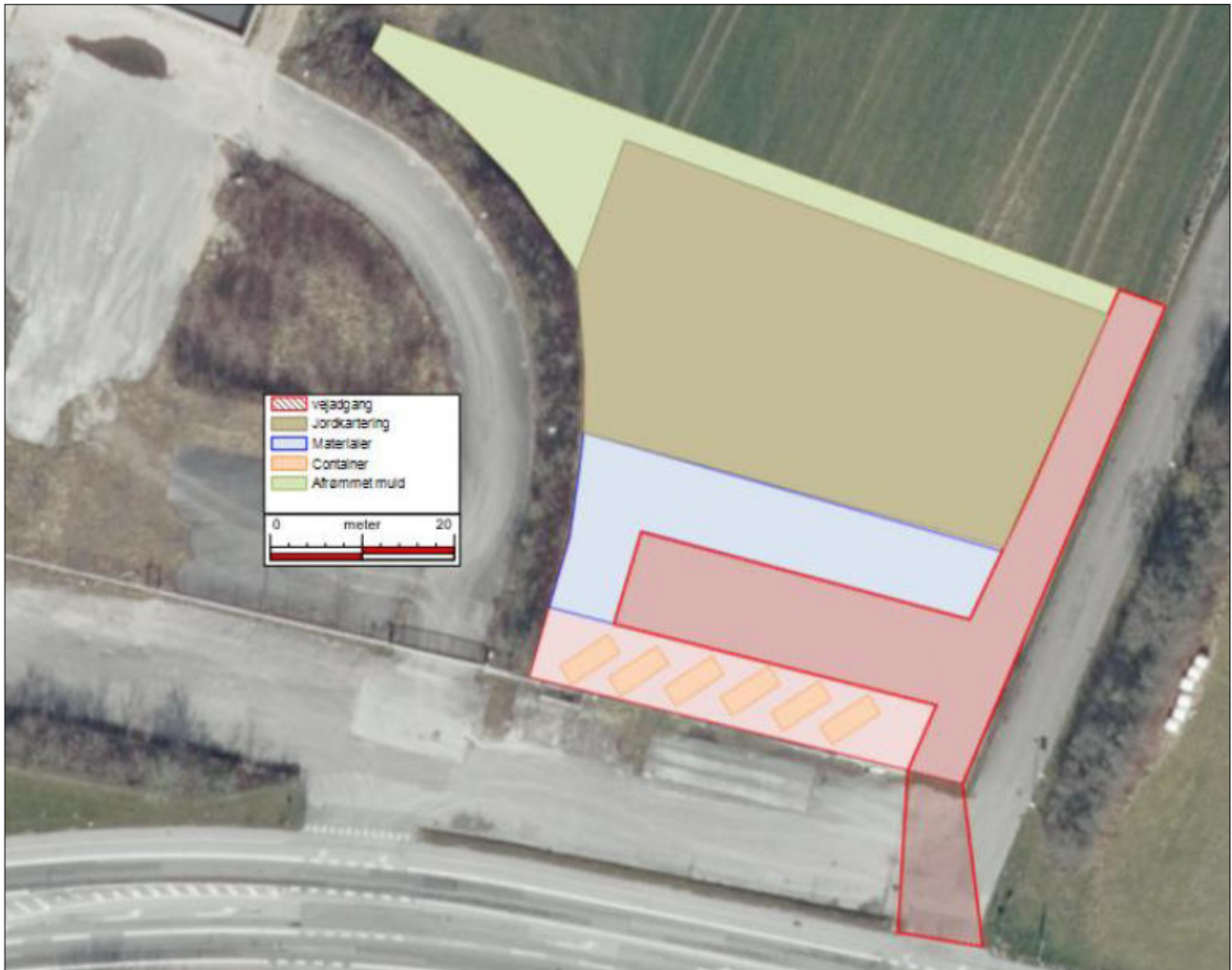
Figur 1: Indretning af pladsen. Materiale fra ansøgning. Lysegrøn skravering angiver oplag af overskudsjord fra rømning af pladsen. Grønbrun skravering angiver plads til jordkartering. Blå skravering angiver plads til materialer. Orange skraveringer angiver placering af containere og rød skravering angiver indkørsel og interne køreveje.
