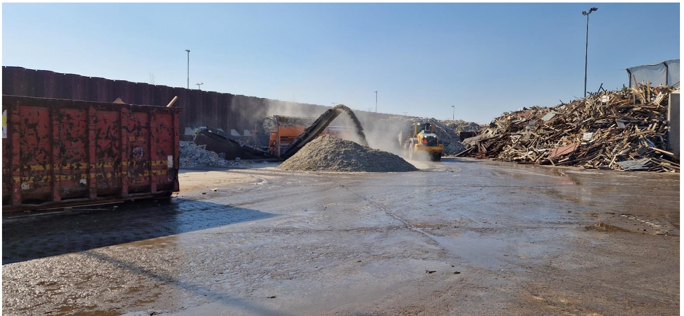
Maskinen renser isoleringsaffald ved at fjerne andre affaldsfraktioner som plast m.m. Der foretages befugtning for at minimere støvgener.
