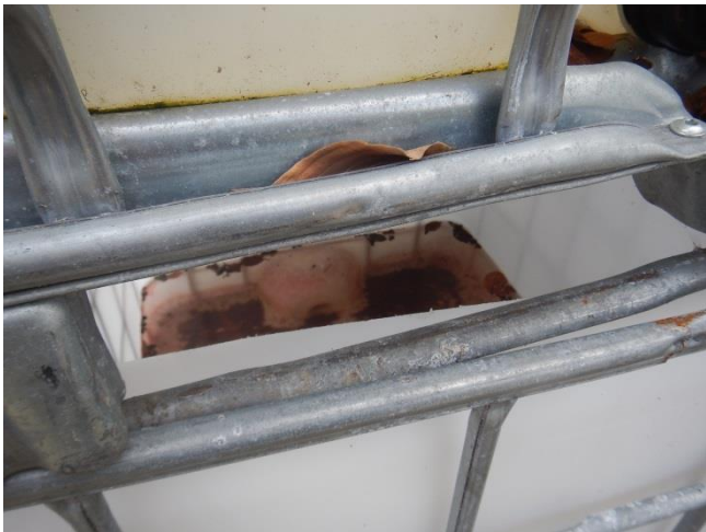
20. Udendørs oplag af pallettanke -ikke returembalage. Her en uden top og med indhold af regnvand.
