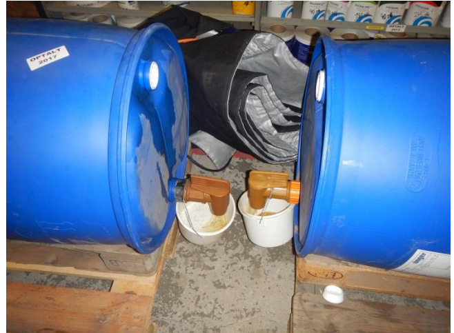
2. Indendørs oplag af råvarer/hjælpstoffer på tæt betongulv, på paller m spildbakker
