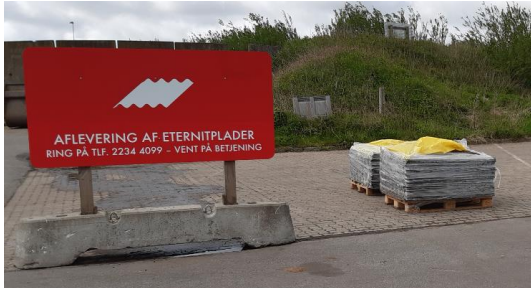
Billede 3 Emballerede asbestplader på modtageplads umiddelbart syd for brovægt og personalebygning.
