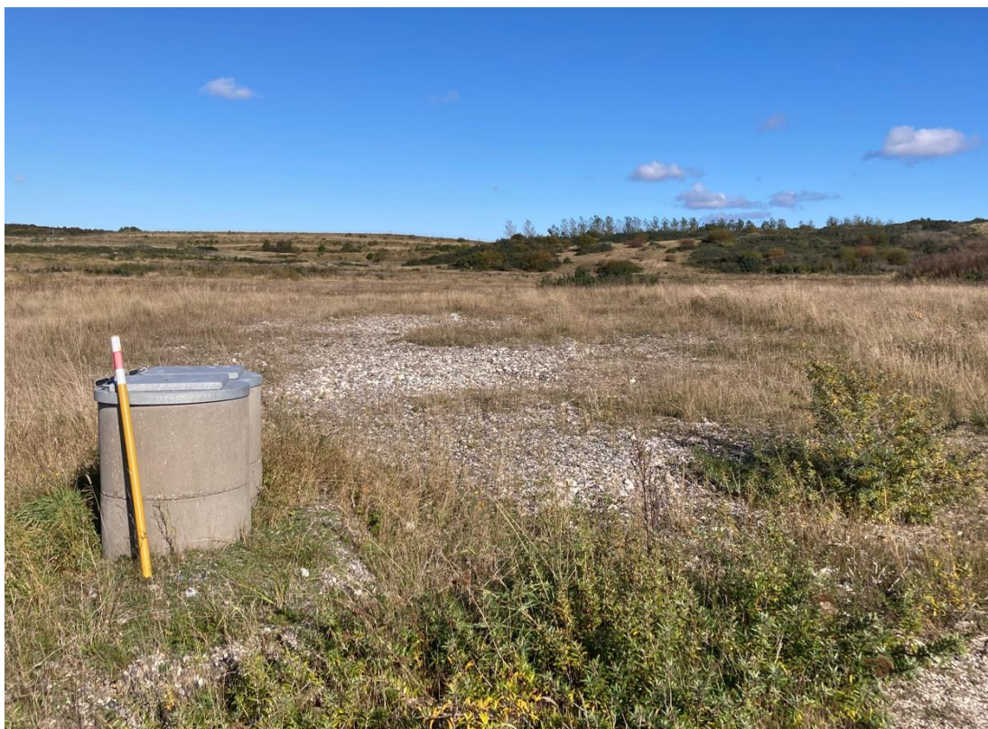
Foto 3. B7. Boringen har 2 filtre.
