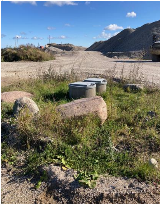
Foto 2. B3 er afskærmet med sten. Boringen har 2 filtre.
