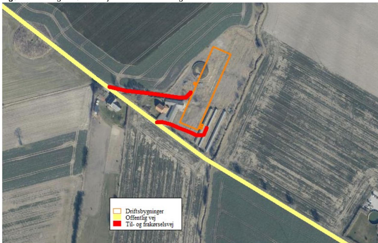
Figur 4.1. Til- og frakørselsveje til bedriftens anlæg.
