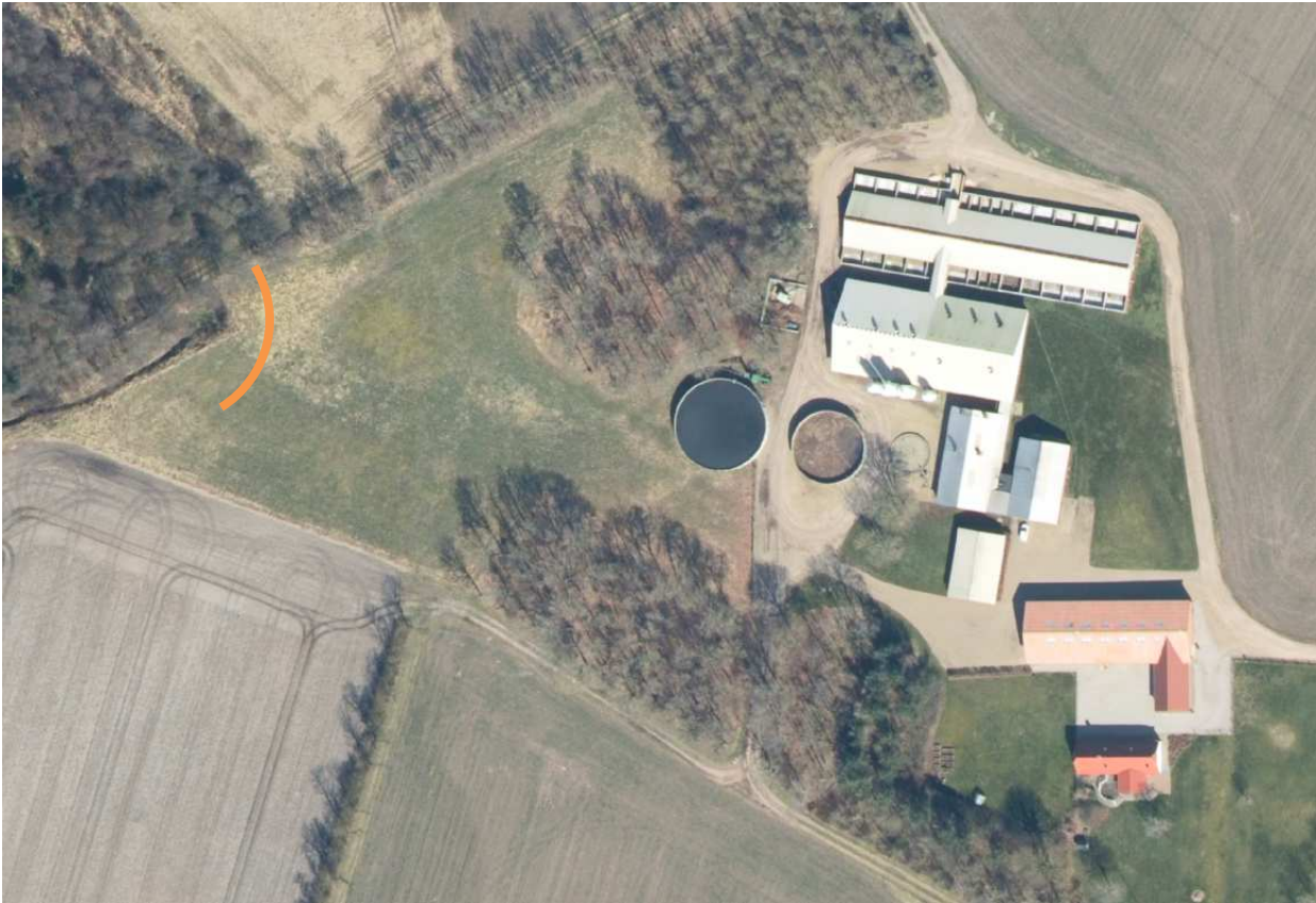
Figur 8. Spærring af grøft i tilfælde af uheld
