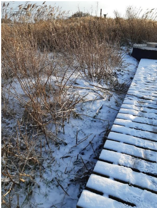
Foto 2: Biocover B5 i deponiets vestlige del, beliggende tæt på kanten af deponiet. Af billedet fremgår, at komposten stadig står højt her i forhold til broen.
