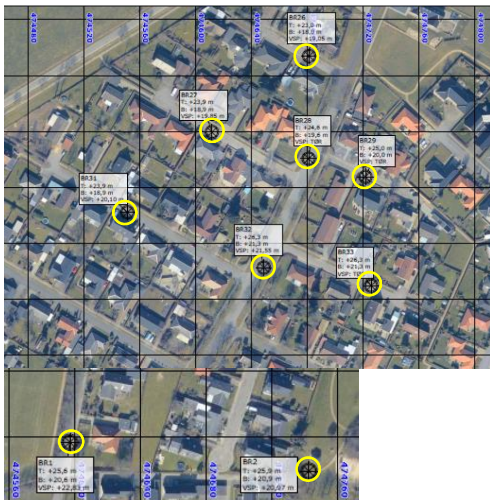
Figur 3 Oversigt over borer udført i Næsbjerg, henholdsvis nordligt ved Skoleparken, og sydligt ved Knoldeflodvej. I borerne markeret med gult er der udtaget jordprøver /2/.
