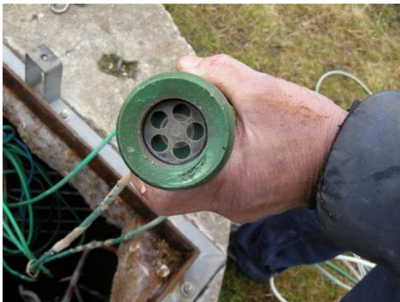
Figur 3.16 Tryktransmitter optaget fra CP3.
