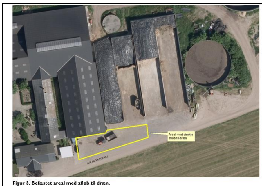
Figur 12 Areal hvorfra vand tidligere blev ledt til dræn, men som nu opsamles med vand fra plansiloer
