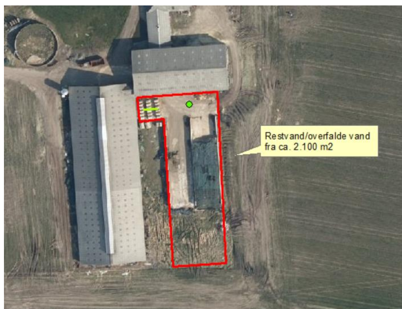
Figur 10. Der opsamles fra ca. 2.100 m 2 i alt fra vaskeplads, møddingsplads og ensilagesiloer efter udvidelsen, som ledes til gyllesystemet.
