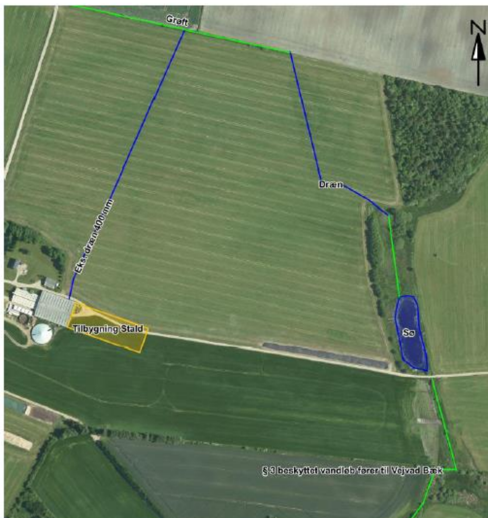
Figur 2 Afledning af tagvand over marken
