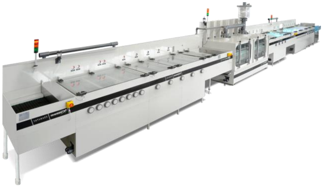
Figur 2 Eksempel på processtyr til ætsning
