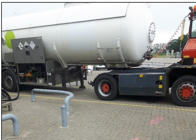
Figur 46 Eksempel på påfyldningsanlæg på tankbil. Foto: WH-PlanAction
