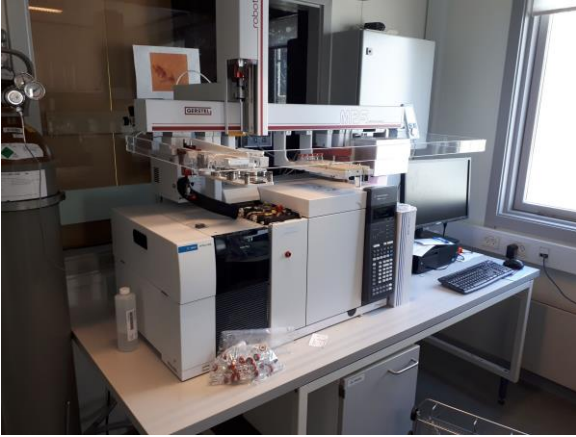
Gerstel MPS: analyseapparat til bl.a. miljøfremmede stoffer, herunder PAH.
