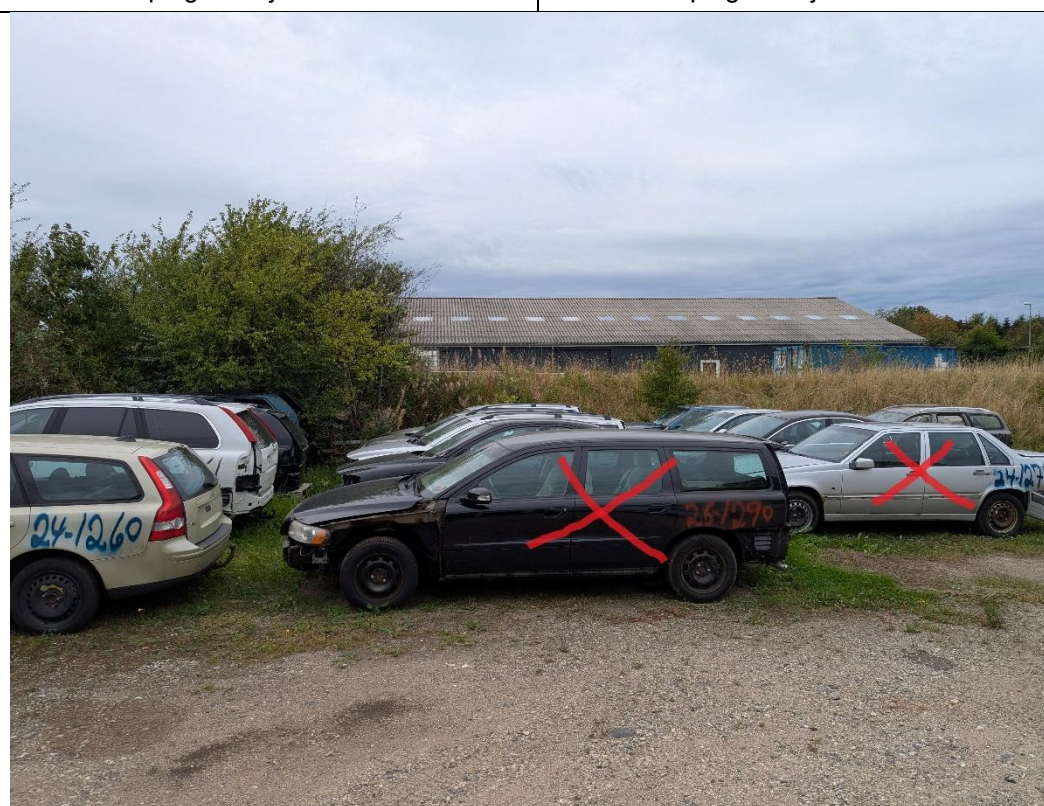
Billede 9. Miljøbehandlede biler med påbegyndt demontering. Biler markeret med kryds indeholdt motorer med henblik på salg (delvist miljøbehandlede).
