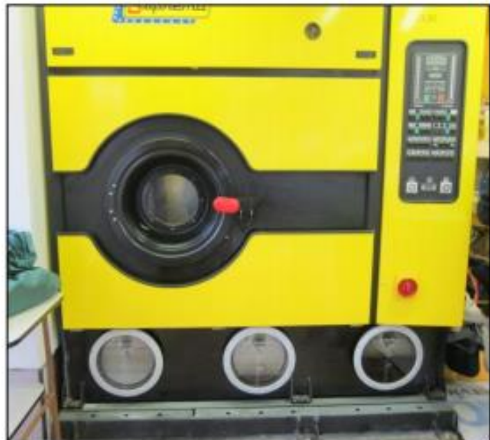
Renserimaskinen i ekspeditionslokalet. De tre "luger" indeholder rensesvæske i forskellige stadier, afhængigt af, hvor brugt væsken er eller hvor meget det er blevet genbrugt. Den rene perchlor er til venstre i billedet. Den mest brugt (mørkest) er til højre i billedet. Den mellemste luge er mellemstadiet.
