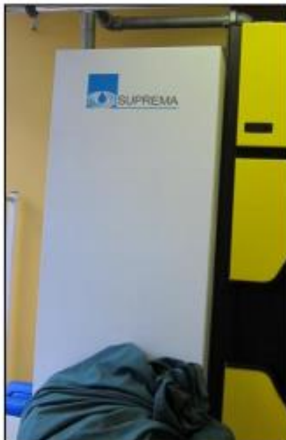
Suprema regenererer kulfilteret efter hver 12. vask, hvilket tager omkring 30 min. Regenereringsmaskinen er placeret til venstre for renserimaskinen.
