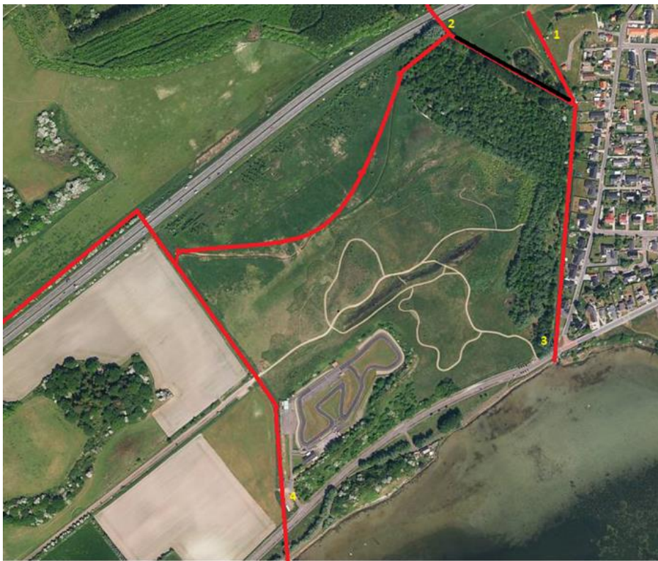
Figur 2. indretning af dræn omkring Fyldpladsen. Prøvestationer er nummeret med gul.
