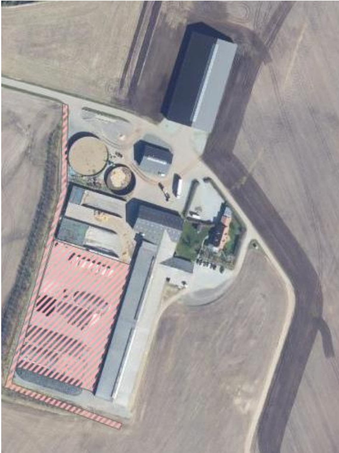
V2-kortlagt - (Påvist forurennet) Område med rød skravering. Her er der foretaget indbygning af støberisand.
