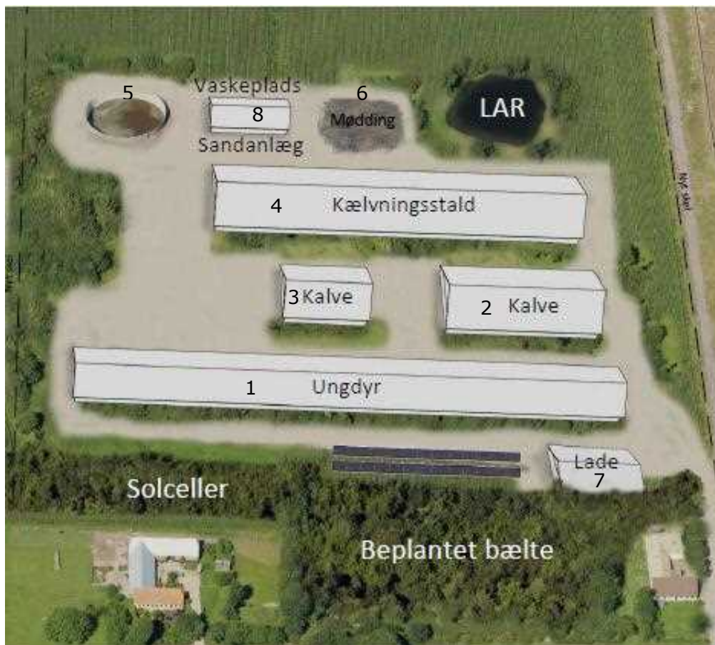
Kort 1: Situationsplan (sandanlægget som fremgår af skitsen, er taget ud af projektet). LAR er et foreløbigt forslag til placering af et regnvandsbassin
