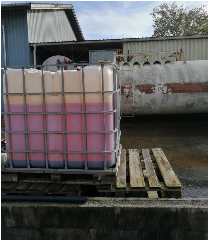
Billede 3: Pallettank med olieslam fra ammoniakanlægget (2019)
