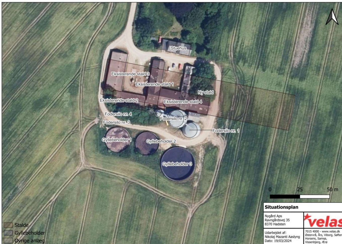
Figur 3 Situationsplan for husdyrbruget på Ravngårdsvej 35. Både de eksisterende og de to ansøgte stalde er vist på kortet (De to nye stalde er indtegnet som én, da afstanden mellem stalderne vil være meget lille). Ligeledes er de tre eksisterende gyllebeholdere vist.
