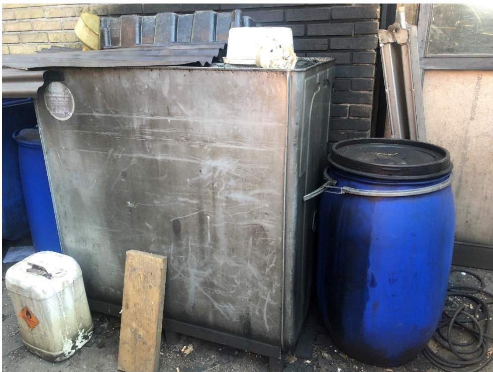
Billede 1. Plastic beholdere med oliefiltre samt spildolietank.
