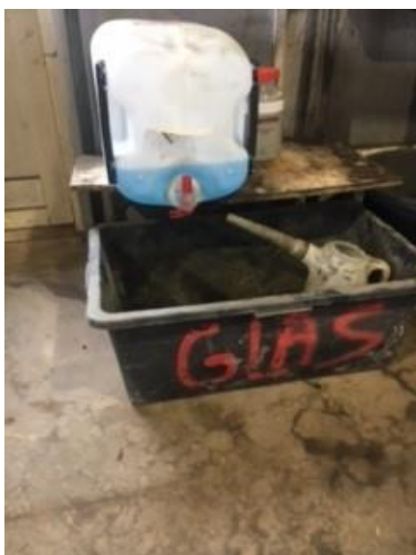
Billede 1. Spildbakke under køler/sprinklervæske i værksted.
