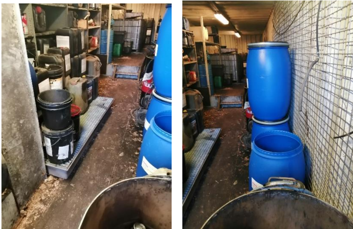
Billede 3. Ny spildbakke til oplag af kemikalier/olier og olieaffald samt ekstra spændefade til oliefiltre.
