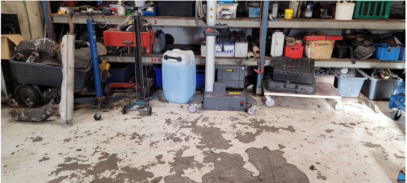
Oplag af kemi i større plastdunk uden spildsikring.
