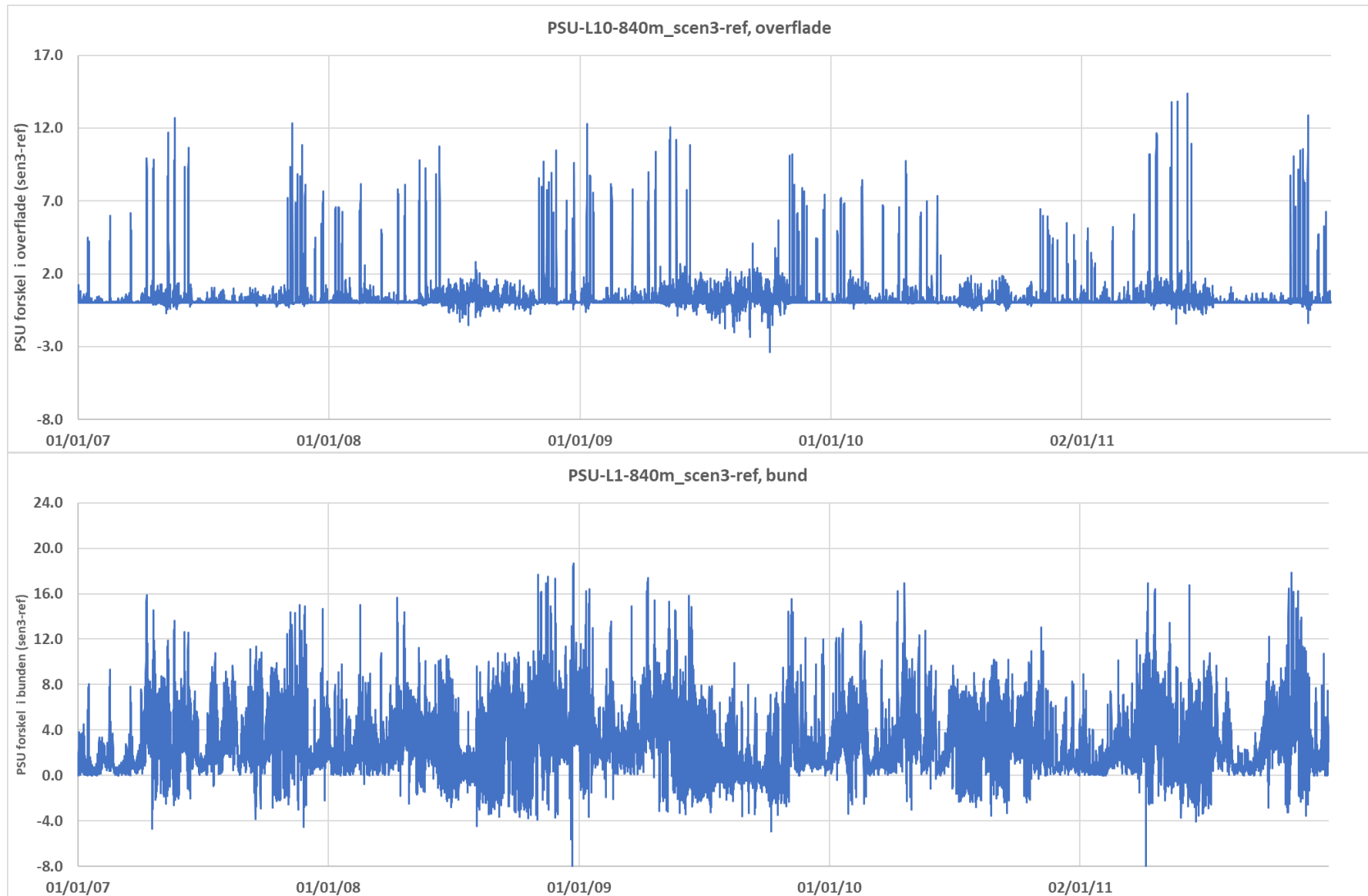
Figur A - 10 Salinitetsforskel i scenarie 3 modtryk minus referencen. Øverst: Salinitetsforskel i overfladen 840 m fra åmunding. Nederst: Salinitetsforskel bundlag 840 m (ved sammenløb Gamle Kanal og Å) fra åmunding.
