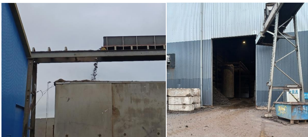
Billede 3: På billedet til venstre ses transportbåndet med NF med en ikke inddækket båndende, resulterende i en høj faldhøjde. Til højre ses den åbne port ind til Kold Hal.
