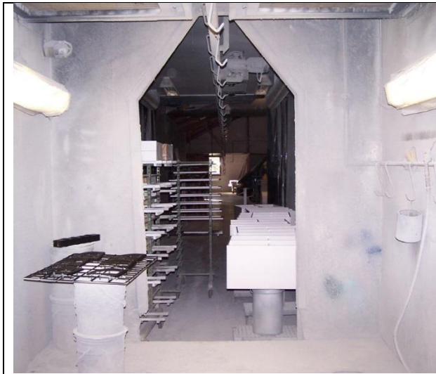
Sprøjtning i halvlukket kabine med syrehærdende/opløsningsmiddelbaserede grunder/lakker
