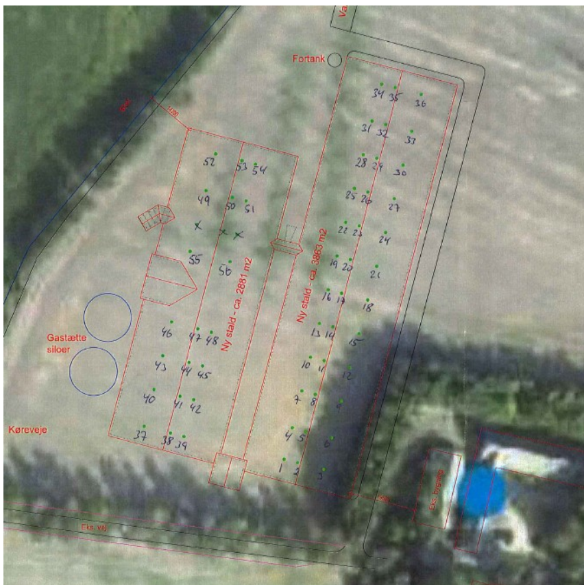
FIGUR 2 PLACERING AF AFKAST 1-56 PÅ DE TO NYE STALDBYGNINGER
